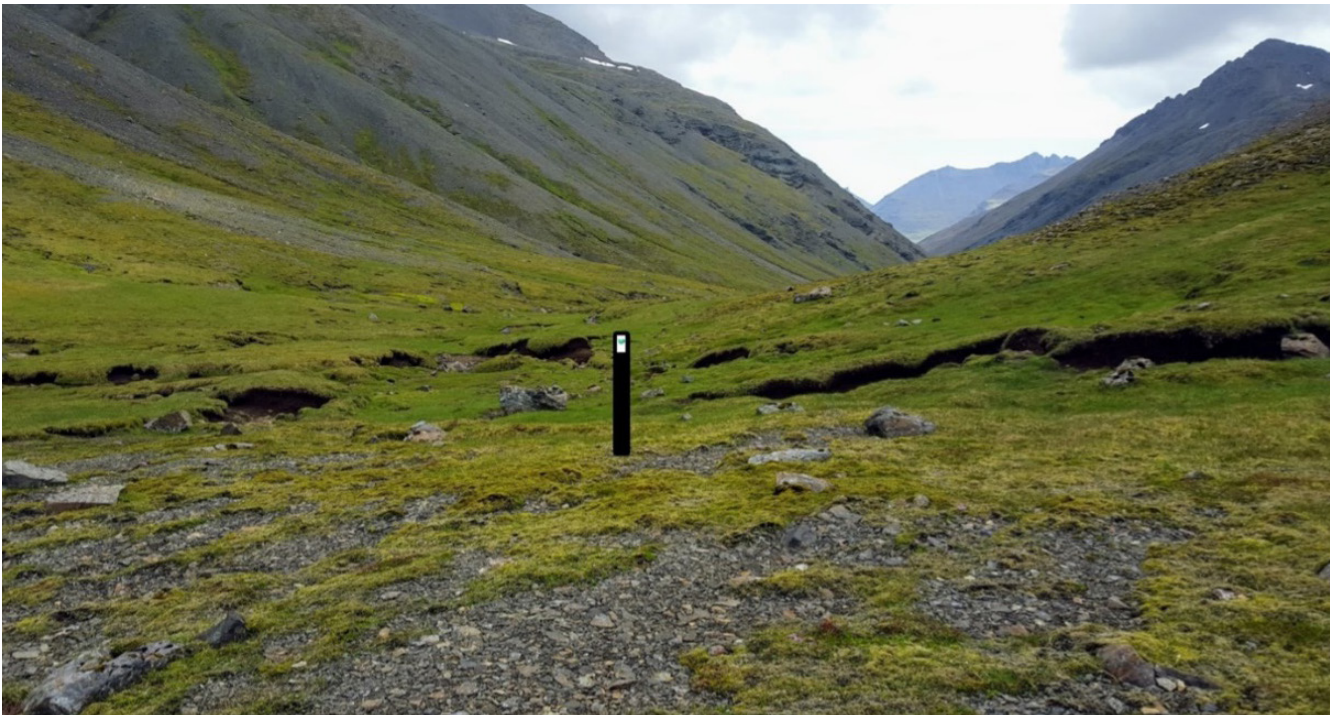
Mynd 2. Dæmi um mælireit. Stikan er sett niður bæði til að finna reitinn aftur fyrir endurmælingar og til að virka sem núllpunktur fyrir mælingar og ljósmyndir.
