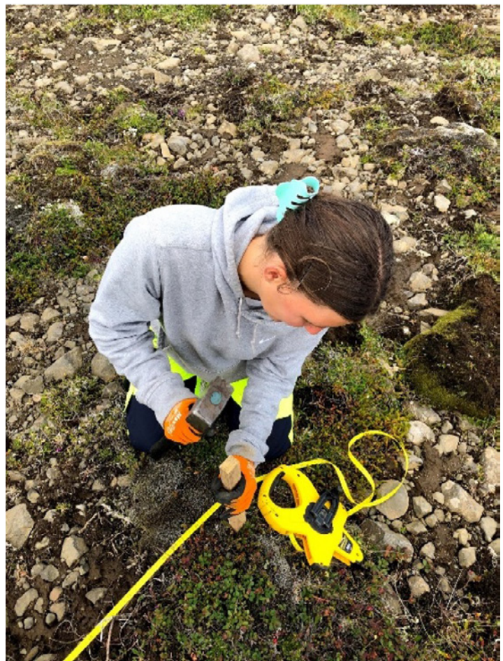
Mynd 4. Tréhæll í norðurpunkti rekin niður með sleggjuhamri við 50 metra markið á málbandinu.
