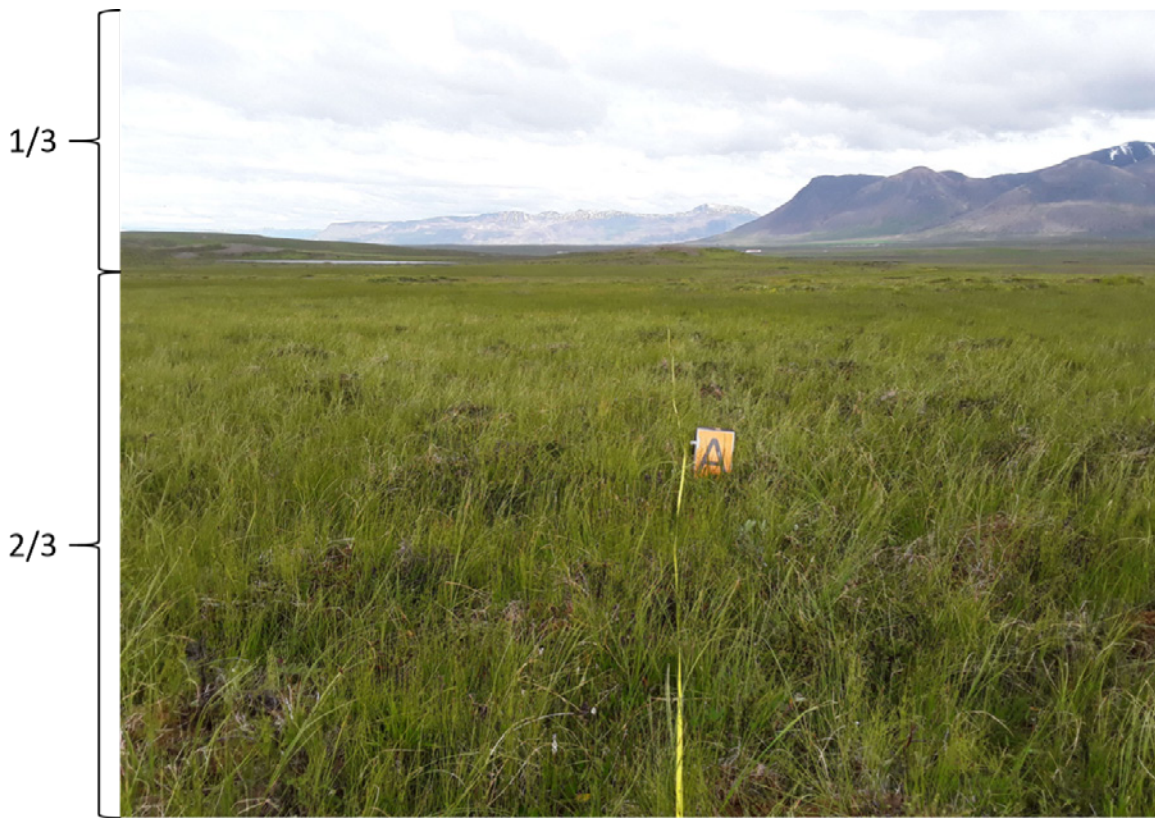
Mynd 8. Ljósmynd af austursniði, tekin við miðstaur, í 150 cm hæð og um 1/3 af myndinni sýnir sjóndeildarhringinn. Spjald merkt A er lagt á línu í 5 metra fjarlægð frá miðstaur. Línan er fyrir miðju á myndinni og hvorki er notað leiftur né aðráttur.
