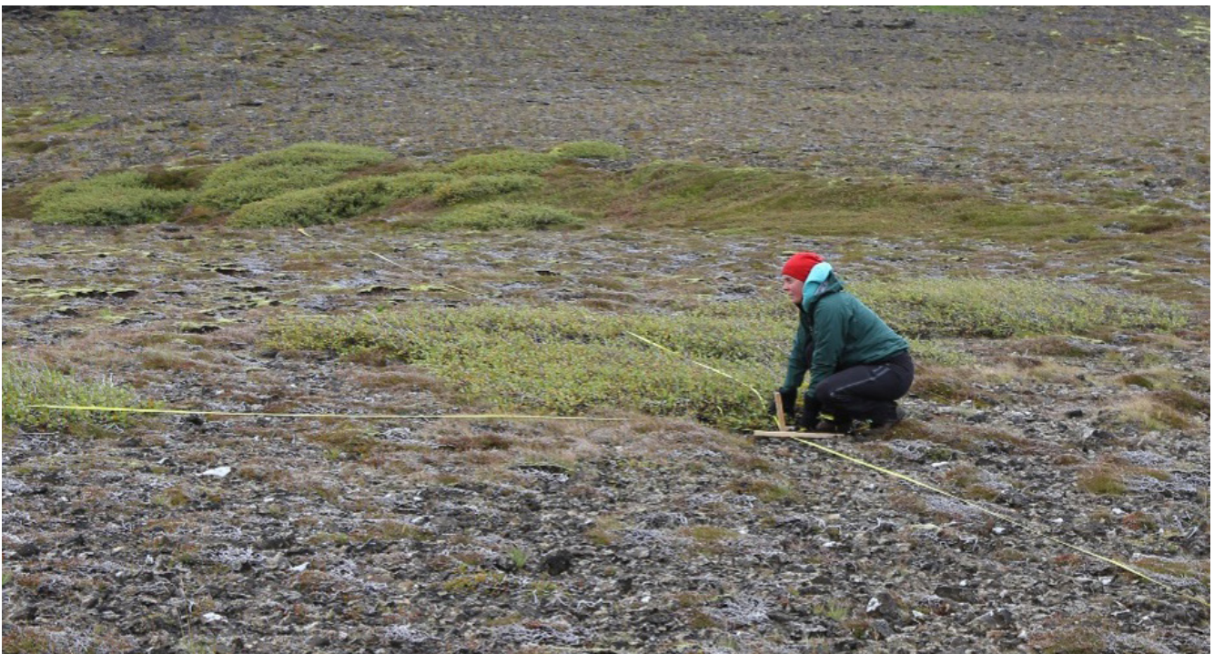
Mynd 5. Það er mikilvægt að tryggja að sniðin séu hornrétt hvort á annað, snúi í höfuðáttir og að málböndin liggi bein og strekkt. Í miklum vindi getur þurft að skorða málböndin föst með járnhælum.
