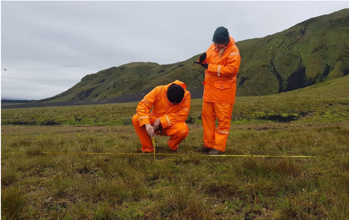
Mynd 18. Gróðurhæð mæld á sniði. Alla jafna er best að tveir vöktunaraðilar sameinist um gróðurhæðarmælingar, þar sem annar mælir á meðan hinn skráir. Sá sem mælir rekur stikuna blint niður u.þ.b. á réttum stað við málbandið og mælir efstu snerntingu rótfasts gróðurs við stikuna.
