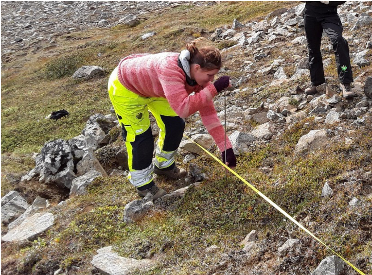
Mynd 19. Jarðvegsdýpt er mæld með svokölluðum jarðvegsprjóni sem er stungið niður í jarðveginn. Prjóninn er merktur með hökum á 10 cm bili til að einfalda mælingar.
