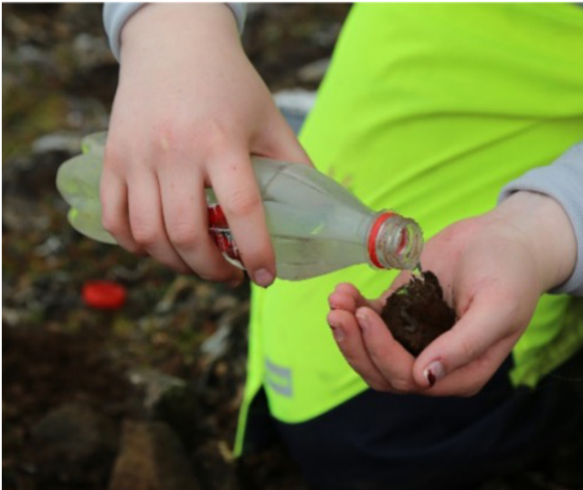
Mynd 11. Handfylli úr efstu 5 cm jarðvegs er mulin niður í höndunum og varlega bleytt upp í jarðveginum til að hnoða í kúlu.
